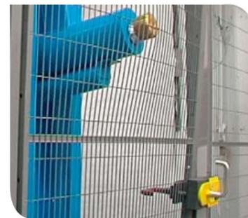
Les Safe Lock sont soumises à des tests de fonctionnement et de résistance aux impacts
