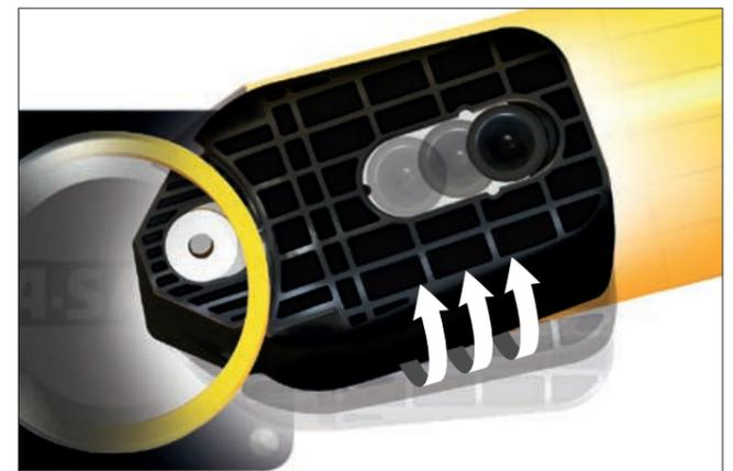
**PHASE 3:** Quand l'énergie est au maximum, l'accouplement tourne encore, engageant la goupille et provoquant la torsion du poteau afin de dissiper les forces restantes.
