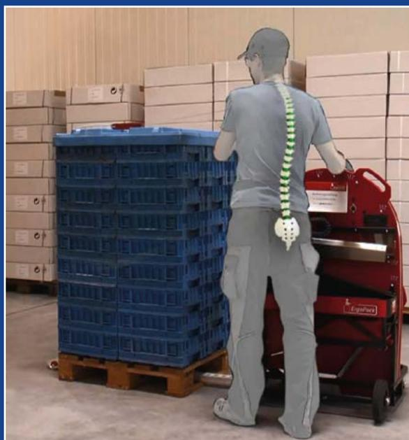
Charges sur la colonne vertébrale lors du cerclage de palettes. Comparaison entre le cerclage manuel avec manche à balai et le cerclage avec une machine de cerclage ergonomique.
