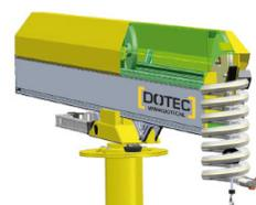
La pression d'air comprimé qui déplace le piston amène la charge «en équilibre». Le piston se déplace en laissant entrer et sortir de l'air comprimé. La tige de piston est reliée à une vis à billes qui est reliée à la bobine. De cette manière, le mouvement linéaire du piston est transformé en un mouvement de rotation de la bobine. Cela signifie que le câble métallique s'enroule et se déroule. La charge est donc soutenue en permanence par un coussin d'air.
