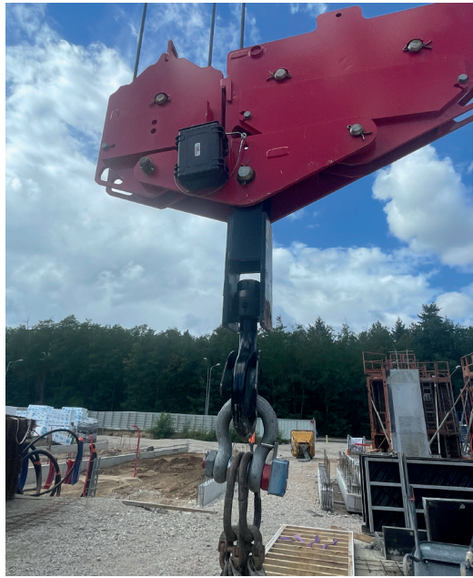
Capteur de géolocalisation centimétrique RTK.42 avec caméra intégrée et peson connecté.
