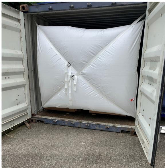
**Bâche de protection gonflable conçue pour sécuriser le transport de colis en vrac.** Grâce au gonflage de la bâche à air comprimée, les mouvements des colis sont limités évitant ainsi leur chute lors de l'ouverture des portes et protégeant également les opérateurs.
