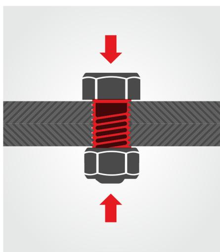
Les assemblages freinés au LOCTITE résistent aux vibrations et permettent en général **d'avoir plus de 25% d'augmentation du couple de desserrage.**
