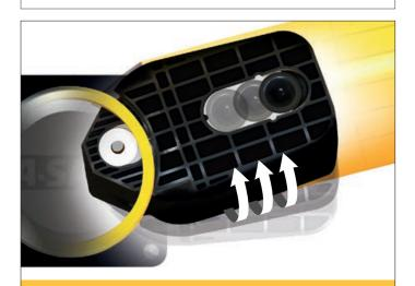
PHASE 3: Quand l'énergie est au maximum, l'accouplement tourne encore, engageant la goupille et provoquant la torsion du poteau afin de dissiper les forces restantes.
