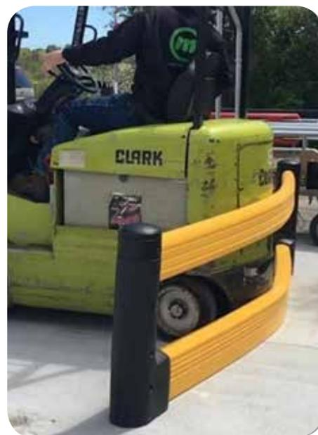
Lors de l'impact, les barrières en polypropylène se déforment et pivotent autour des broches de fixation
