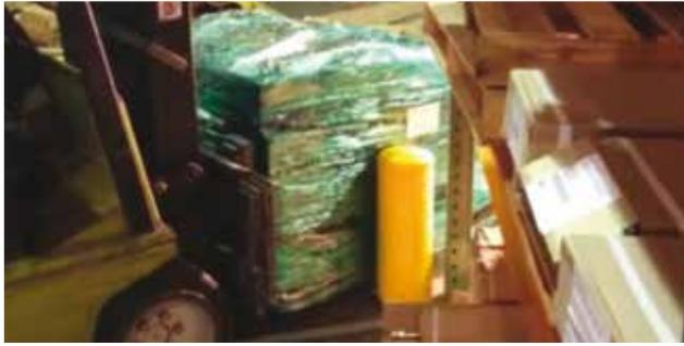
Le poteau **Roller Flex** peut résister à un impact angulaire à 45° d'un chariot de 2948 kg circulant à 28,9 km/h.
