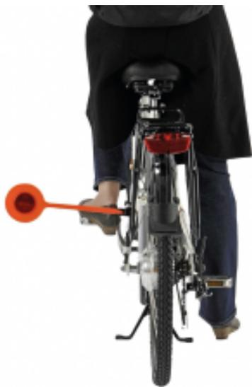
L'écarteur de danger permet de rappeler aux automobilistes qu'une distance de sécurité est nécessaire, notamment lorsqu'ils dépassent un cycliste.
