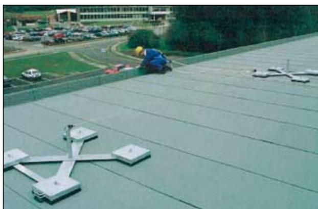
Pour qu'il soit utilisé comme système d'assujettissement, la position du **WIREANKA** et la longueur de la longe doivent garantir qu'il est impossible de s'approcher à moins de 500 mm du bord de la toiture ou d'une autre ouverture.
